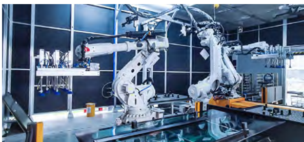
某大型客车厂 视觉引导玻璃上料 & 涂胶
